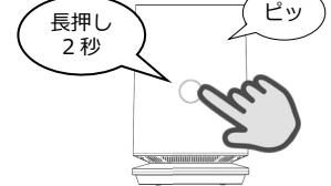
タッチパネル操作部を長押し（約2秒）すると、“ピッ”という音と共に首振り動作します。もう一度長押しすると首振り動作を停止します。
