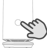
タッチパネル操作部に1回タッチすると、“ピッ”という音と共に運転を始め、風量が表示されます。
