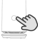
タッチパネル操作部にタッチする度に風量が一段階ずつ増加します。最大の【9】の状態でタッチすると、【1】になります。
